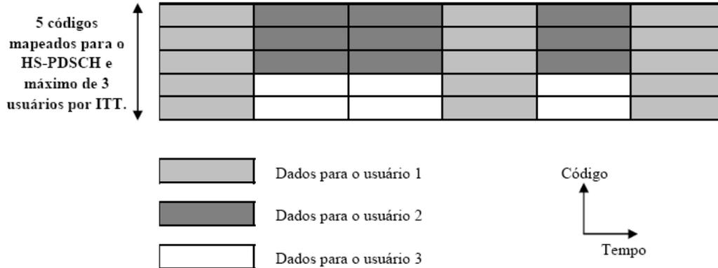
**Figura 3.5:** Compartilhamento do HS-PDSCH por multiplexação de códigos e de tempo.
