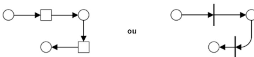
Figura 2.6: Redes de Petri equivalentes: 2 lugares e 2 transições.
