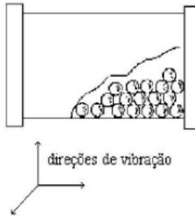
Figura 2.4: Representação esquemática do movimento, em três direções perpendiculares, de um moinho vibratório [Vasconcelos 1999].
