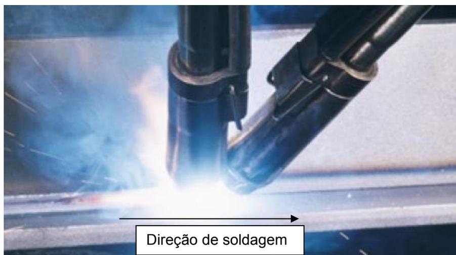
Figura 2.26. Disposição das tochas de soldagem em “tandem”.
