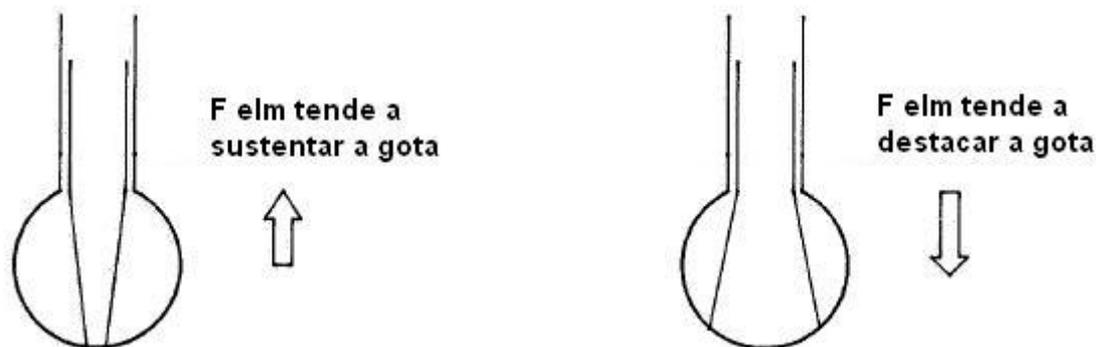
Figura 2.6. Geometria do fluxo de corrente dentro da gota (Norrish, 1992).
