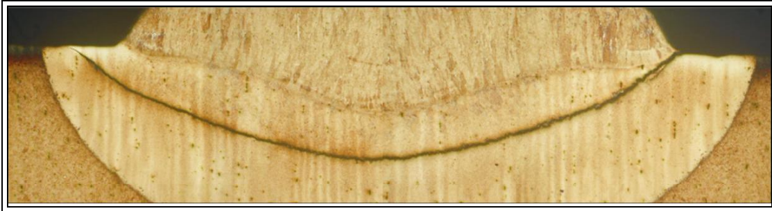
Figura 2.22. Fissuração à frio em aço baixa liga alta resistência AISI 4340 soldado com eletrodo revestido (SILVA et al. , 2006).
