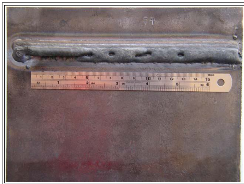
Figura 5.1. Acabamento superficial da amostra soldada com a condição T1.
