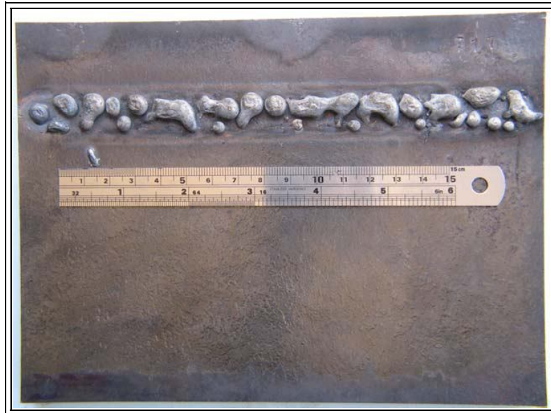
Figura 5.4. Acabamento superficial da amostra soldada com a condição T11.
