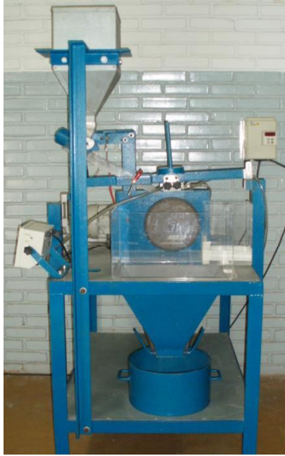
Figura 3.4. Equipamento Roda de Borracha Horizontal do Laboratório de Tribologia e Corrosão dos Materiais da UFES (SCANDIAN & SILVA, 2007).
