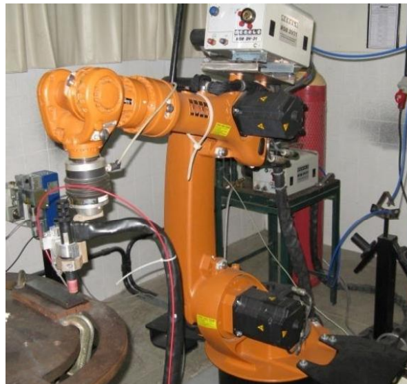
Figura 3.3. Bancada de experimentos II. Robô industrial com sistema de soldagem TIG com alimentação de arame acoplado.
