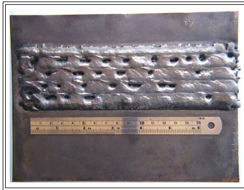
Figura 5.3. Acabamento superficial da amostra soldada com a condição T7.
