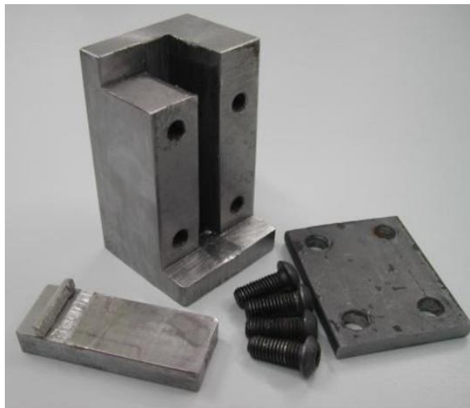
Figura 3.18. Dispositivo para ensaio de arrancamento juntamente com um corpo de prova ensaiado.
