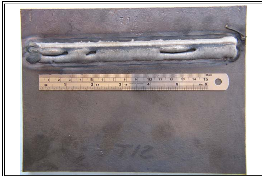
Figura 5.5. Acabamento superficial da amostra soldada com a condição T12.
