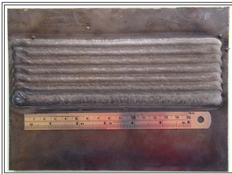
Figura 5.2. Acabamento superficial da amostra soldada com a condição T2.
