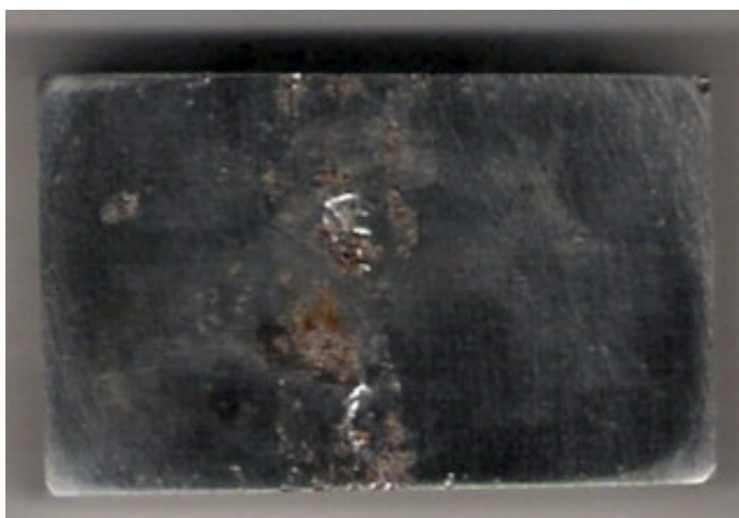
Figura 26 - Amostra de aço inoxidável duplex submetido a uma energia de soldagem de 6\text{KJcm}^{-1} após a imersão por 18h em \text{FeCl}_3 6%.
