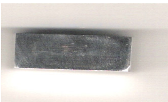
Figura 29 - Amostra de aço inoxidável duplex submetido a uma energia de soldagem de 9\text{KJcm}^{-1} após a imersão por 18h em \text{FeCl}_3 6%.
