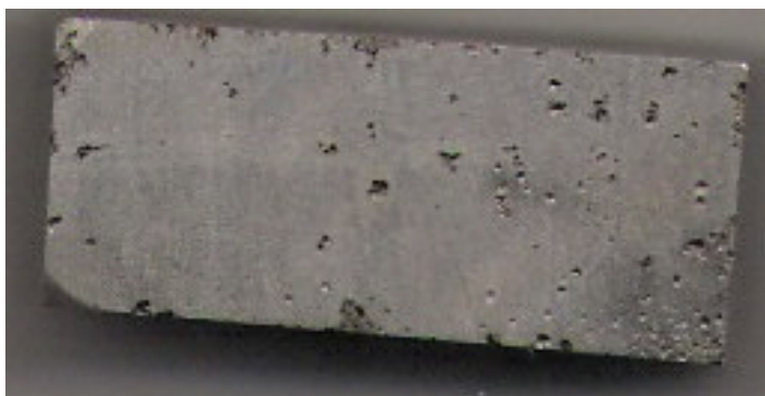
Figura 25- Amostra de aço inoxidável duplex submetido a uma energia de soldagem de 12\text{KJcm}^{-1} após a imersão por 72h em \text{FeCl}_3 6%.
