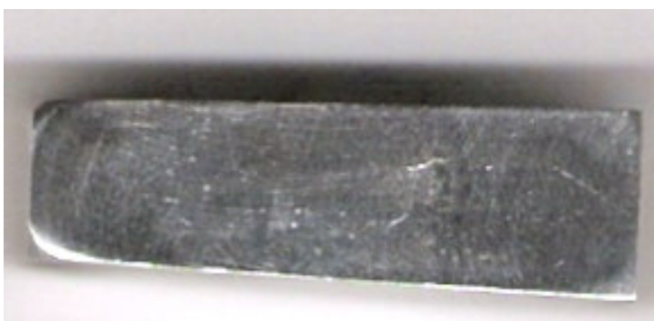
Figura 28 - Amostra de aço inoxidável duplex submetido a uma energia de soldagem de 18\text{KJcm}^{-1} após a imersão por 29h em \text{FeCl}_3 6%.
