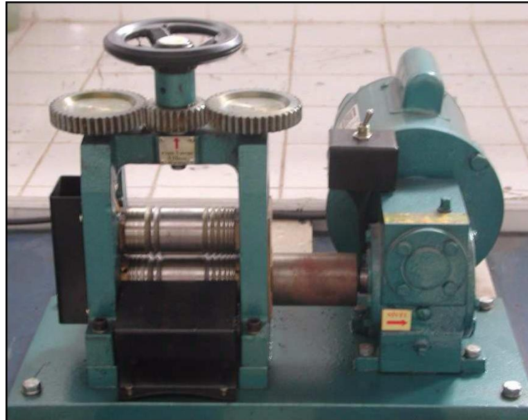
Figura 4.1. Laminador de bancada (LACAM)
