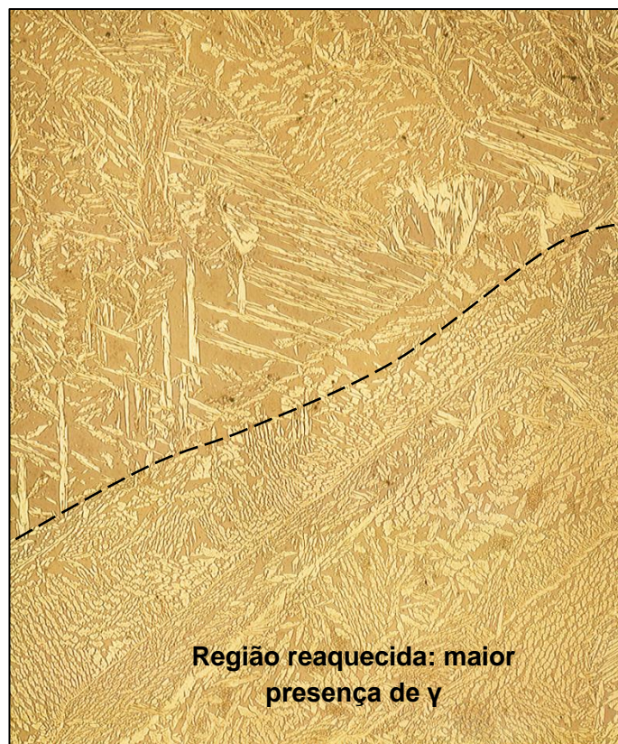
Figura 34. Micrografia da ZF da junta soldada na condição J4 onde o passe anterior apresenta uma microestrutura mais refinada. Montagem, ampliação 200X.
