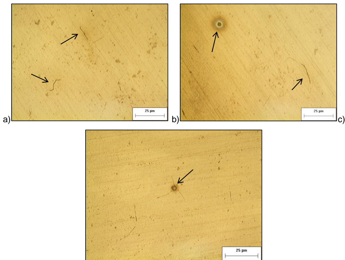
Figura 72. Micrografias obtidas por MO das superfícies das amostras após o ensaio de polarização indicando a formação de pites metaestáveis de amostras das condições: a) J2, b) J1 e c) J7 (raiz).
