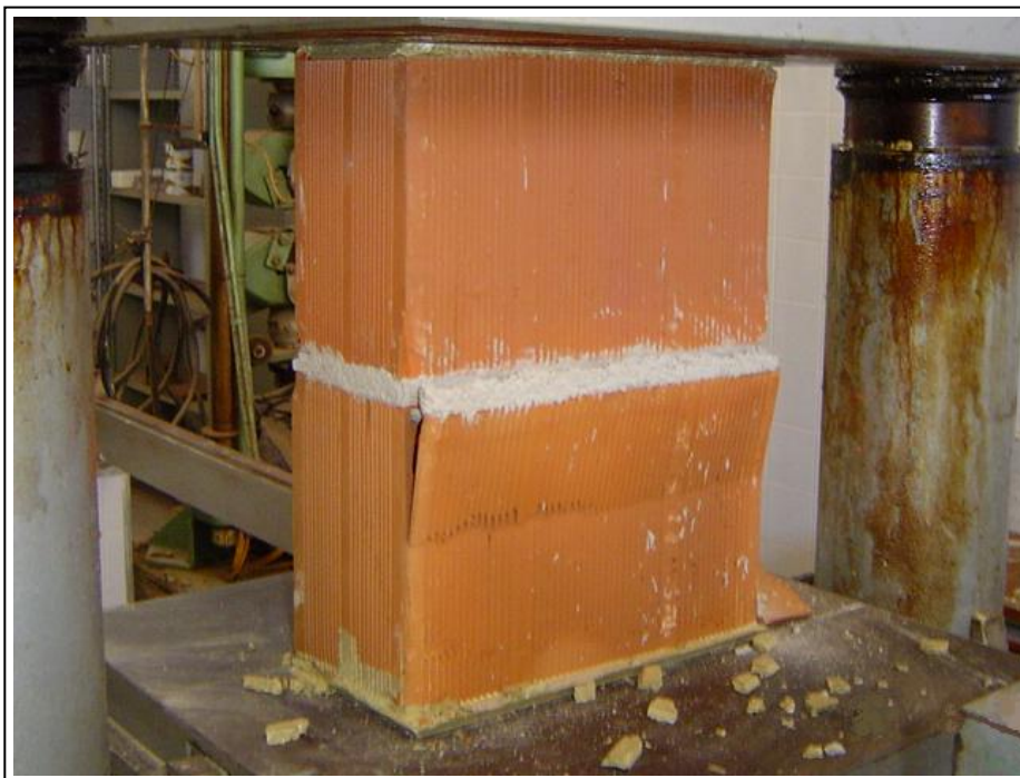
Figura 4.20 – Ruptura do prisma pela formação de plano de ruptura provocada pela tração no bloco com o desprendimento de um grande pedaço.
