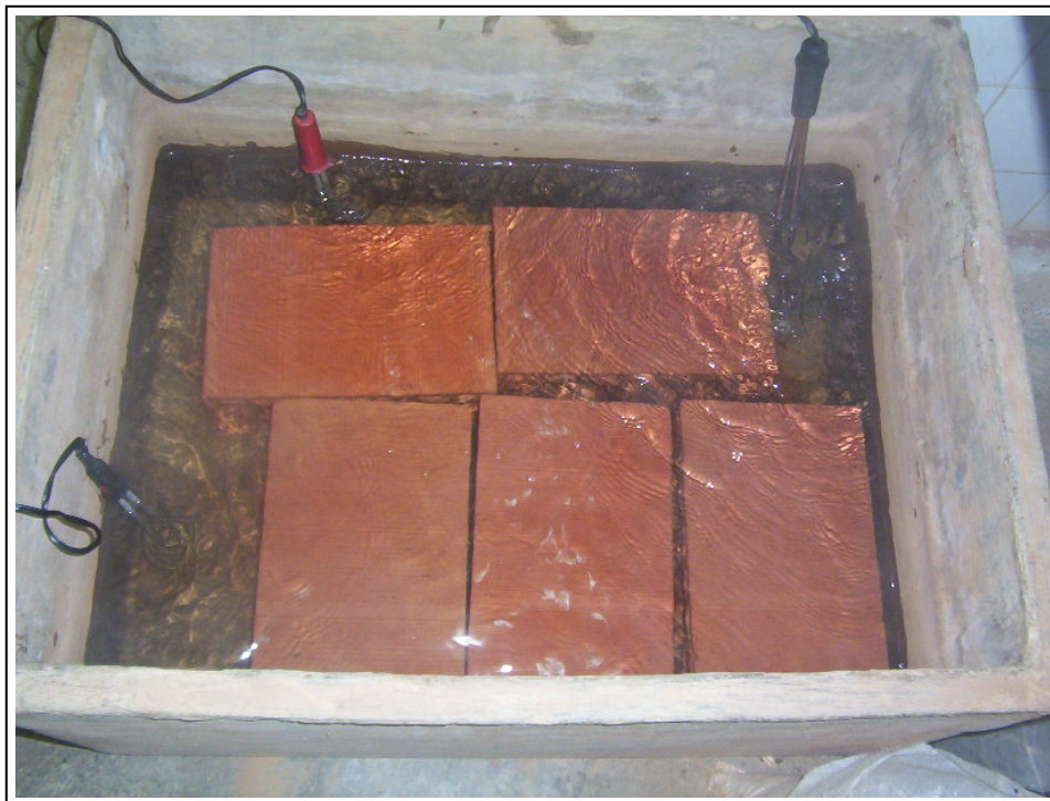
Figura 3.7 - Ensaio de área líquida: blocos imersos em água fervente.
