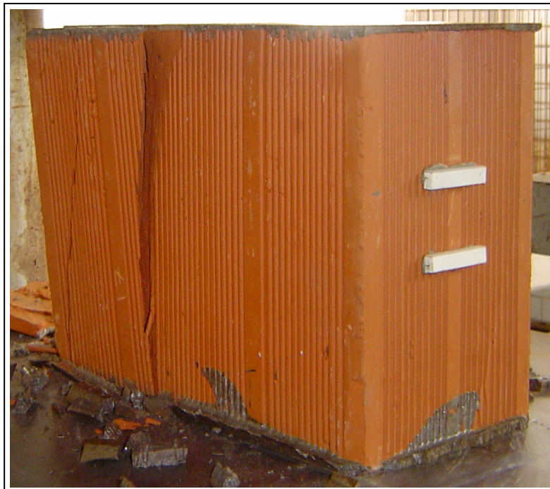
Figura 4.7 - Bloco rompido por compressão. A ruptura se deu segundo um plano vertical, pela separação de “camadas”.
