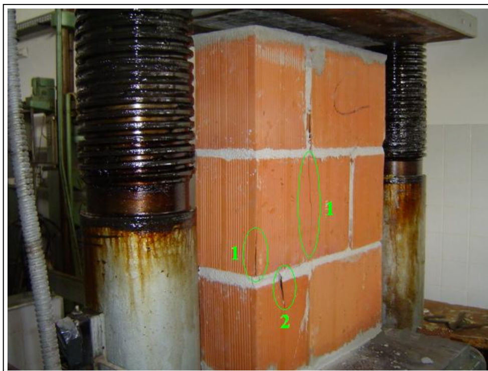
Figura 4.22 – Ruptura de um prisma contrafiados. Formação de trincas verticais ao longo da direção de extrusão (1) e desprendimento de pequenos pedaços (2).
