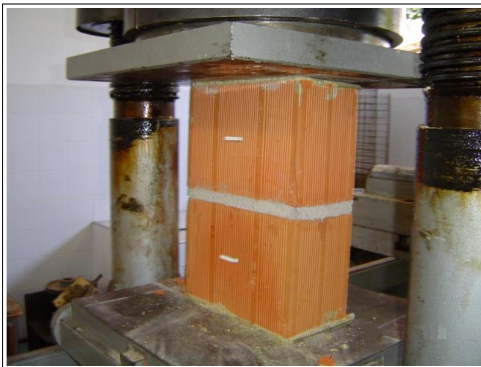
Figura 3.10 - Ensaio de determinação da resistência à compressão dos prismas.
