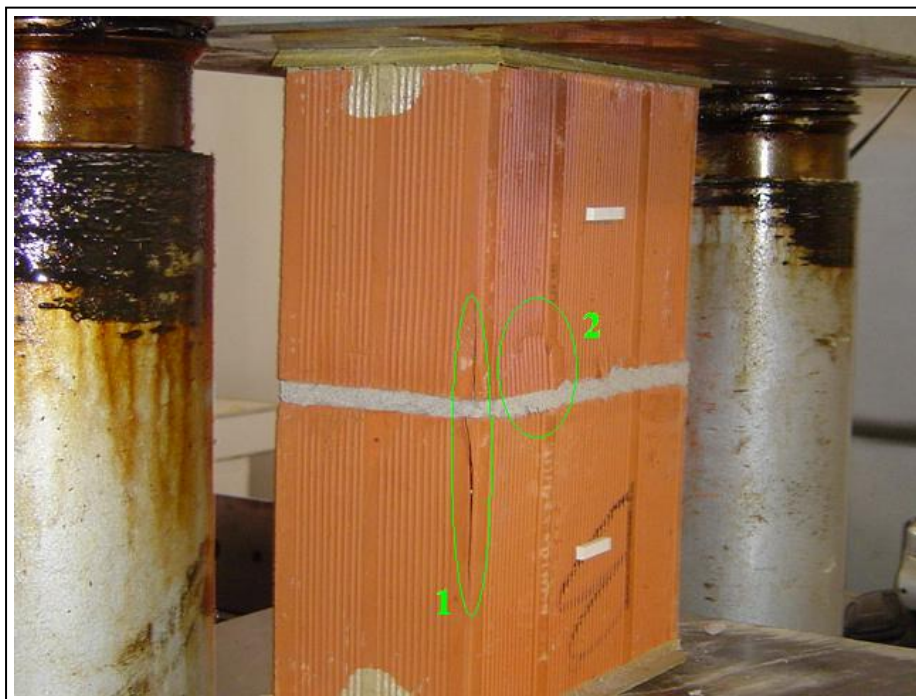
Figura 4.19 – Início de ruptura do prisma pelos blocos. Formação de trinca vertical ao longo da direção de extrusão (1) e desprendimento de pequenos pedaços (2).
