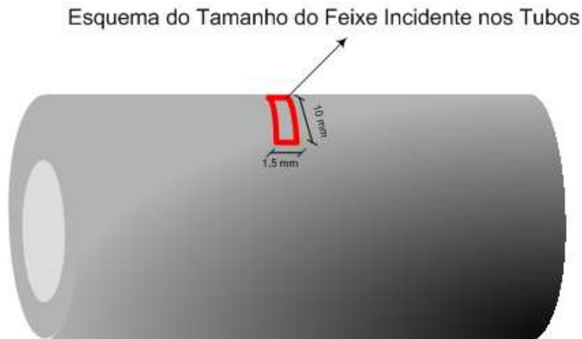
Figura 3.10: Esquema do tamanho do feixe incidente nos tubos.
