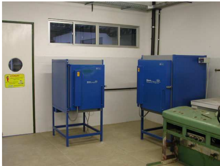
Figura 3.4: Fornos utilizados para os tratamentos térmicos.
