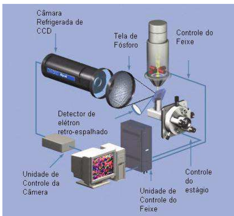
Figura 3.15: Esquema de medição da técnica de EBSD.
