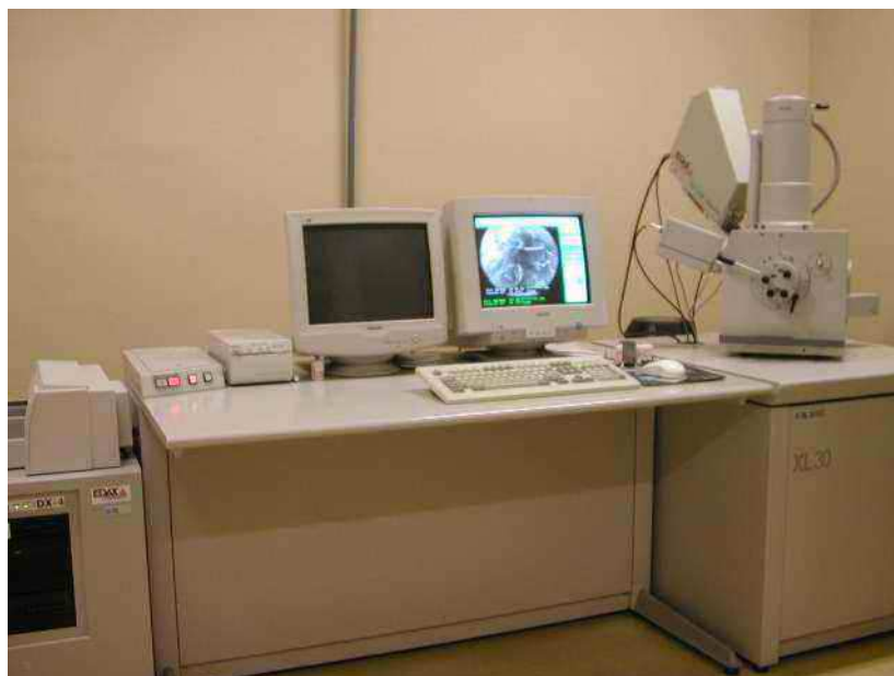
Figura 3.7: Microscópio eletrônico de varredura utilizado para aquisição de imagens metalográficas e EBSD.
