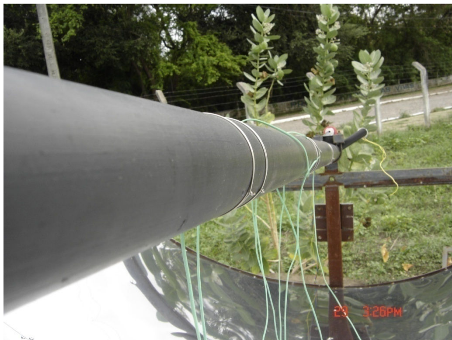
Figura 5.3 - Termopares fixados na superfície externa do tubo adsorvedor.
