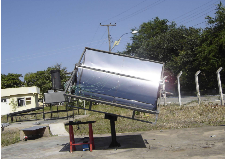
Figura 4.4 - Concentrador Parabólico adequado para receber o sistema de rastreamento.
