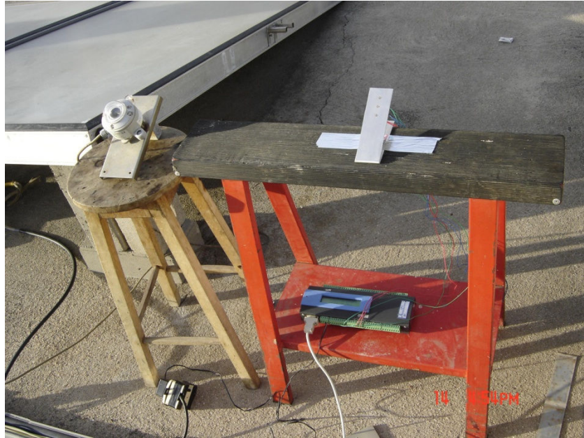
Figura 3.12 - Coleta de dados para verificação do comportamento do LDR em função da radiação solar.
