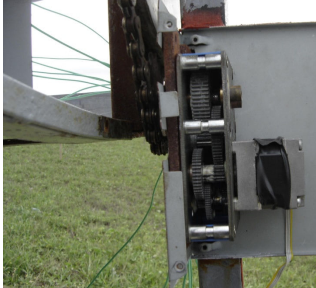
Figura 4.9 - Motor de passo bipolar acoplado a um conjunto de redução para aumento do torque.
