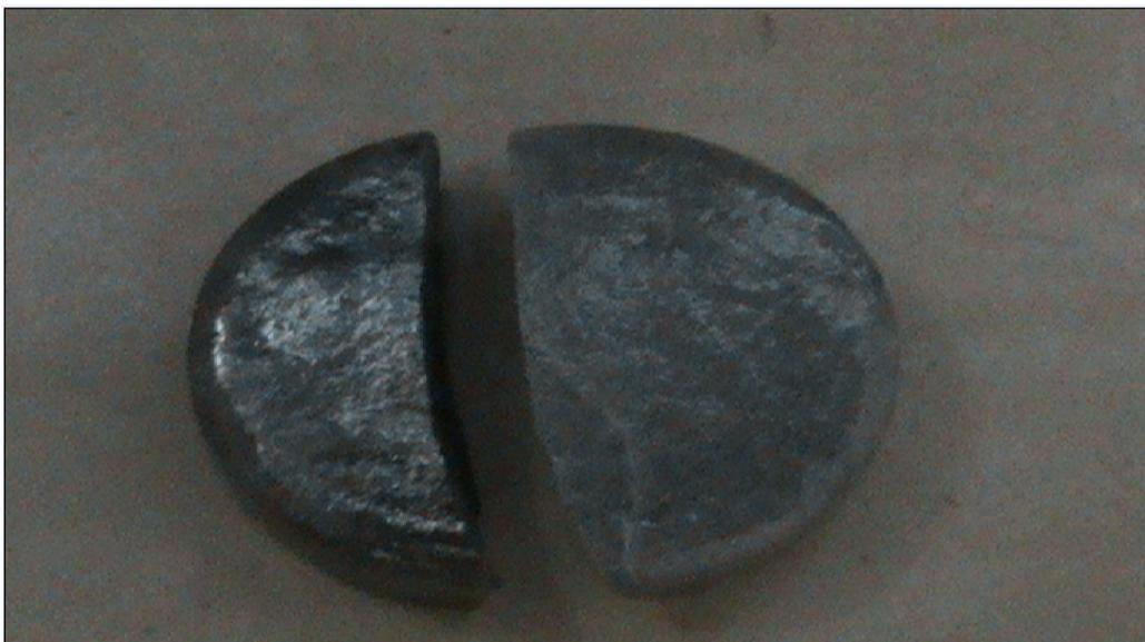
**Figura 26** – Amostra fraturada após ensaio de compressão diametral.
