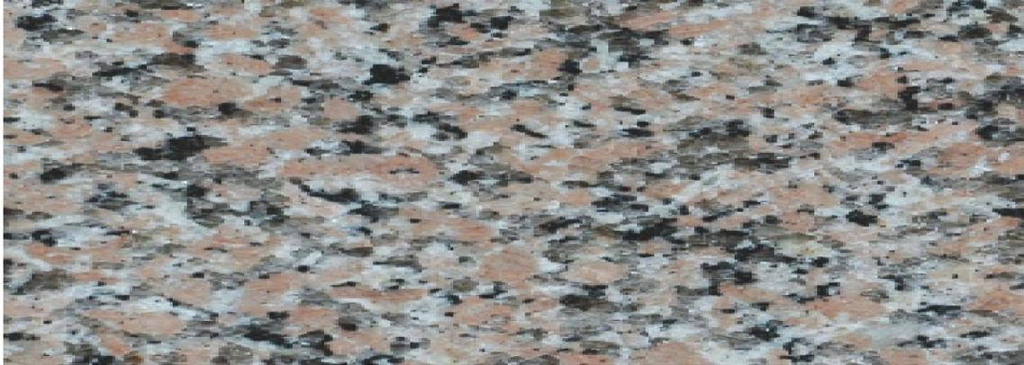
**Figura 8** – Fotografia do Granito Polido Rosa Iracema. Fonte: IMARF GRANITOS E MINERAÇÃO S/A.
