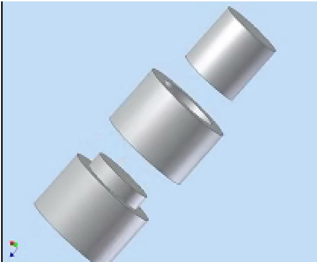
**Figura 15** - Molde Cilíndrico para obter amostras.
