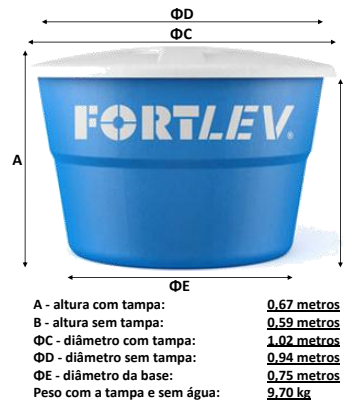
Figura 4. 4 - Dimensões físicas das caixas FORTLEV 310 L
