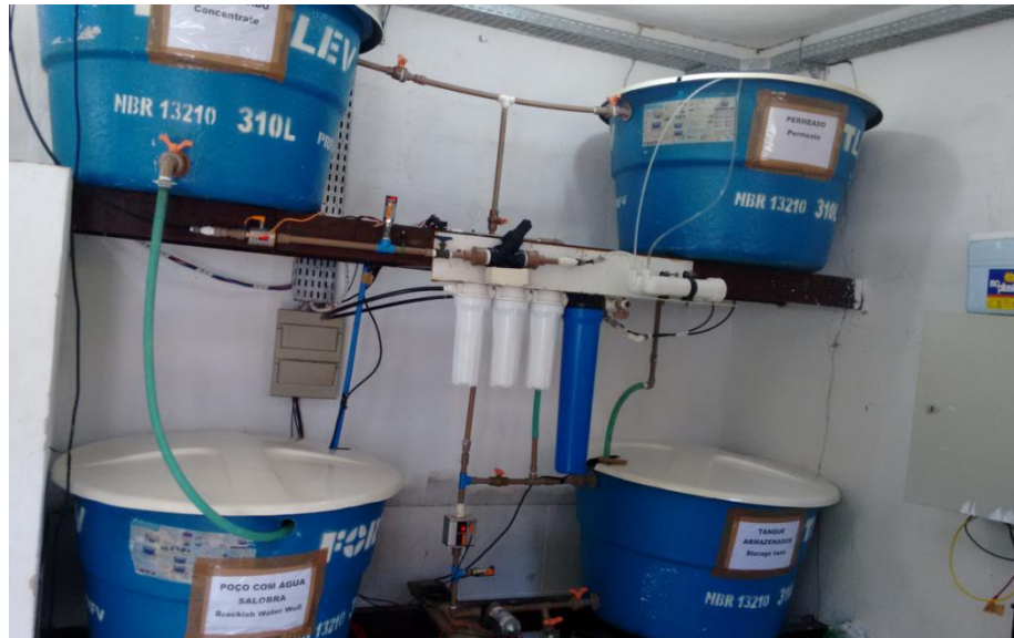
Figura 4. 2 - Planta de dessalinização de água salobra por OR utilizada
