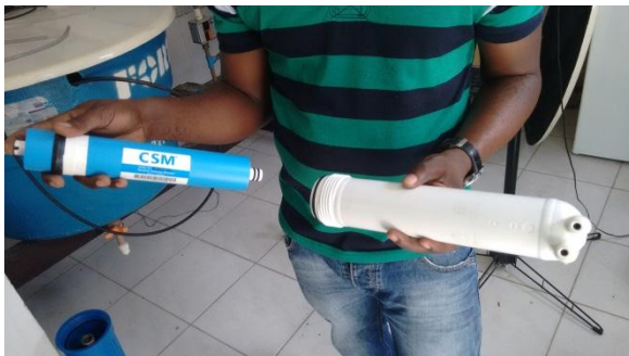
Figura 4. 9 (a) Membranas de OR TW30-1812-100 utilizadas
