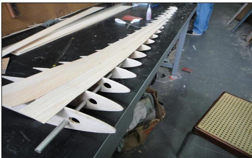
Figura 48- Início de recobrimento de uma pá.
