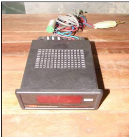
Figura 14 - Tacômetro digital com sensor indutivo de proximidade.
