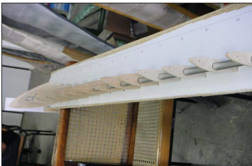
Figura 47 - Montagem dos perfis no gabarito empregando o eixo de referência de alumínio.
