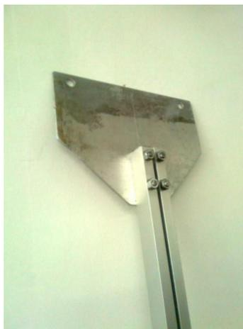
Figura 54 - Detalhe do suporte de alumínio destinado a veleta de orientação.
