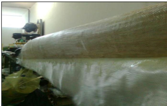
Figura 50 - Aplicação de resina epóxi e tecido de fibra de vidro.
