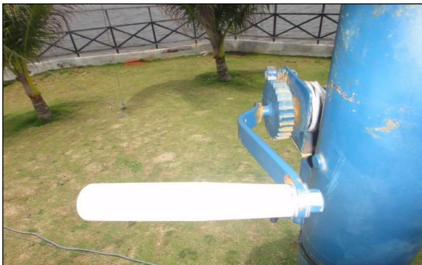
Figura 31 - Modelo de acionamento do freio a tambor na parte inferior da torre.
