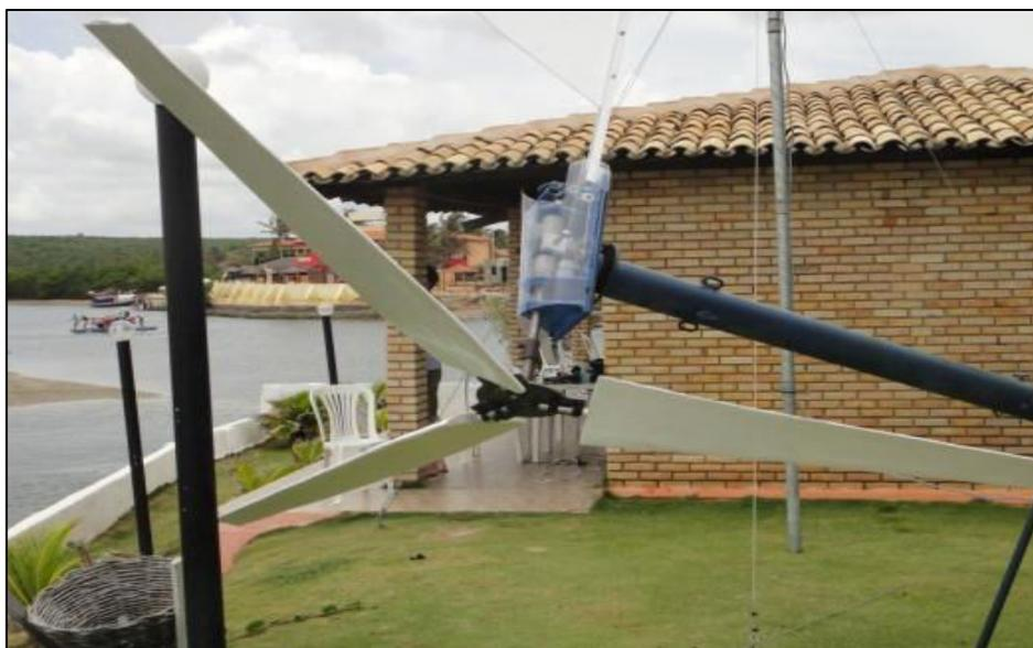
Figura 61 - Sistema completo montado no topo da torre, prestes a ser levantado para início dos testes.
