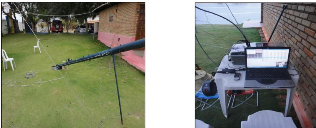
Figura 60 - Torre já tensionada aos estaios laterais e apoiada. Sistema de aquisição de dados.
