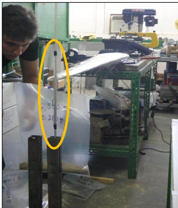
Figura 32 - Posicionamento da pá para ensaio. Detalhe do suporte com régua para medição da deflexão.
