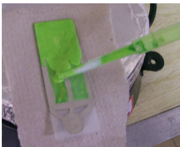
Figura 4.12– Segunda camada de \text{TiO}_2 sendo depositada
