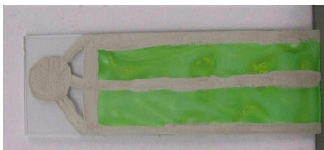
Figura 4.11 – \text{TiO}_2 com corante e o contato elétrico
