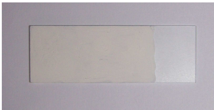
Figura 4.6 – Filme fino de \text{TiO}_2 depositado no substrato
