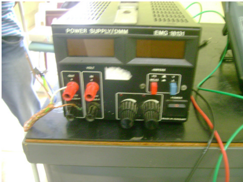
Figura 9.9 – Fonte de alimentação contínua.
