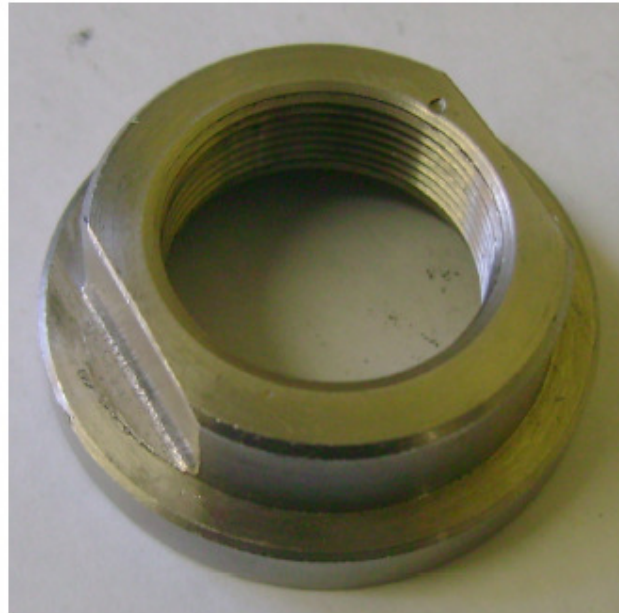
Figura 9.3 – Porca de fechamento do rotor.
