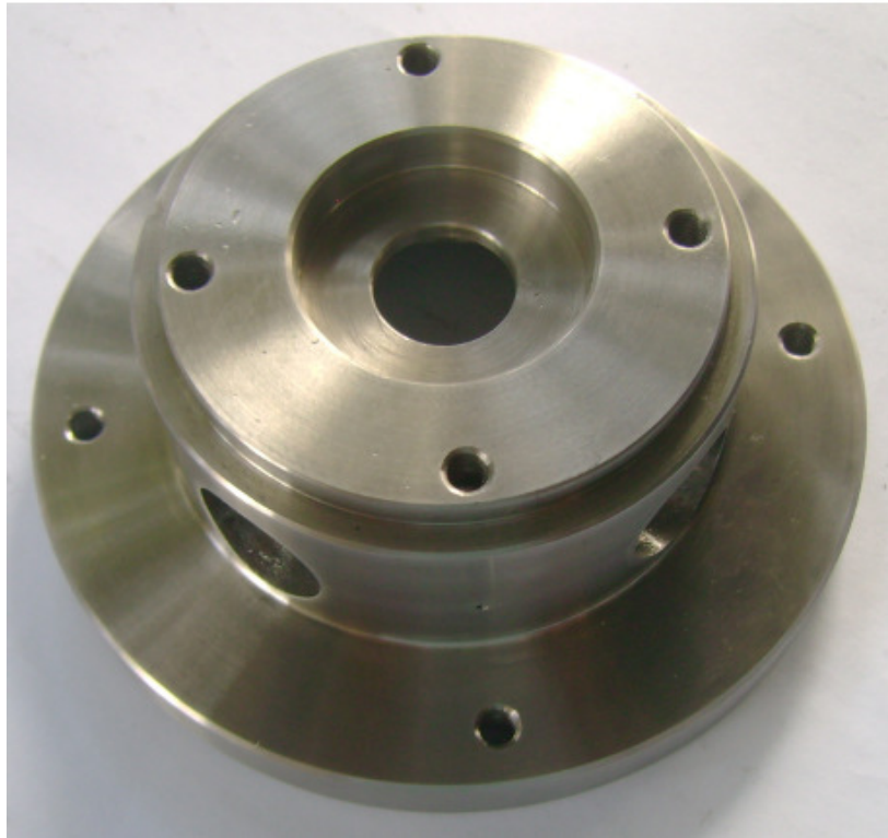
Figura 9.6 – Carcaça de exaustão.
