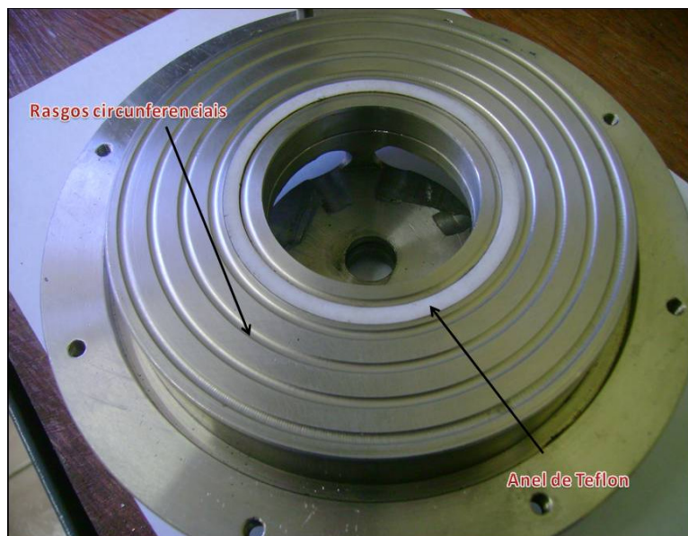
Figura 4.10 - Carcaça alterada
