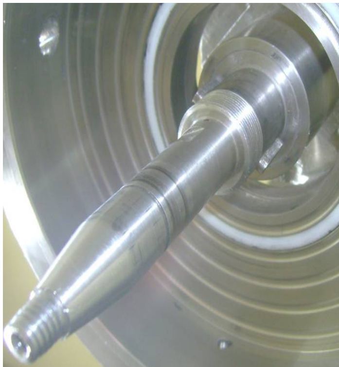
Figura 4.6 – Detalhe do eixo mostrando a possibilidade de variação da quantidade de discos e espaçamentos
