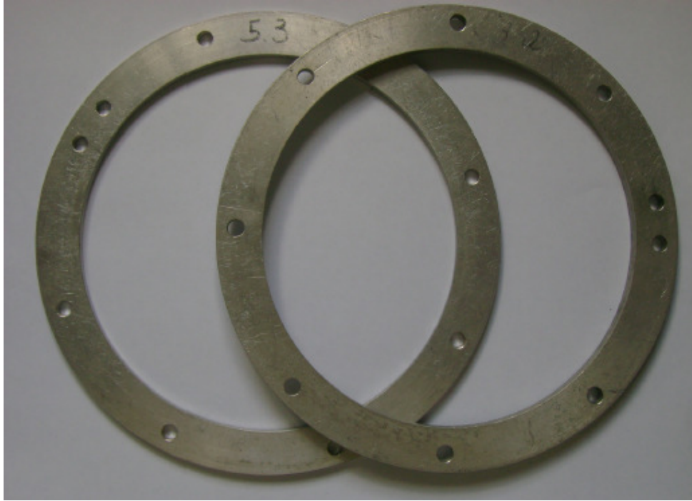
Figura 9.4 – Espaçadores de Alumínio para as carcaças.
