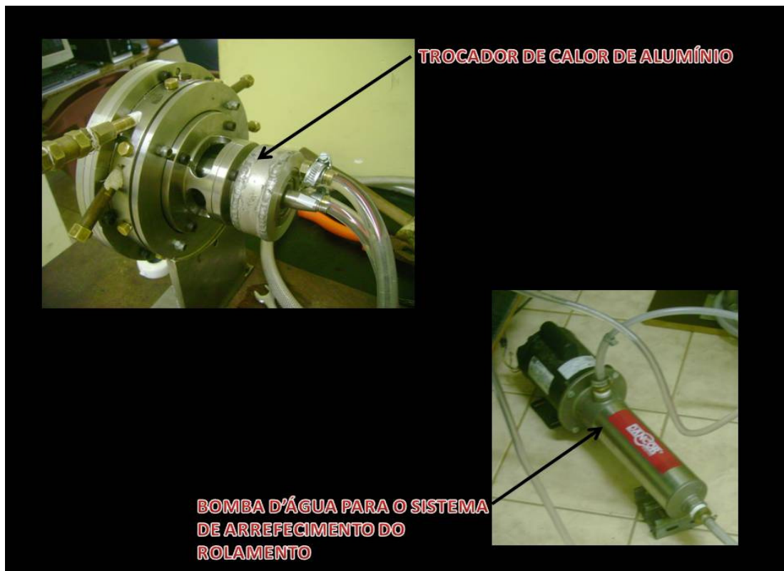
Figura 4.12 – Sistema de Arrefecimento
