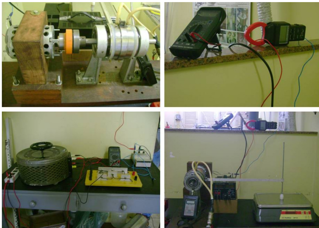
Figura 4.53 – Montagem para calibração do dinamômetro
