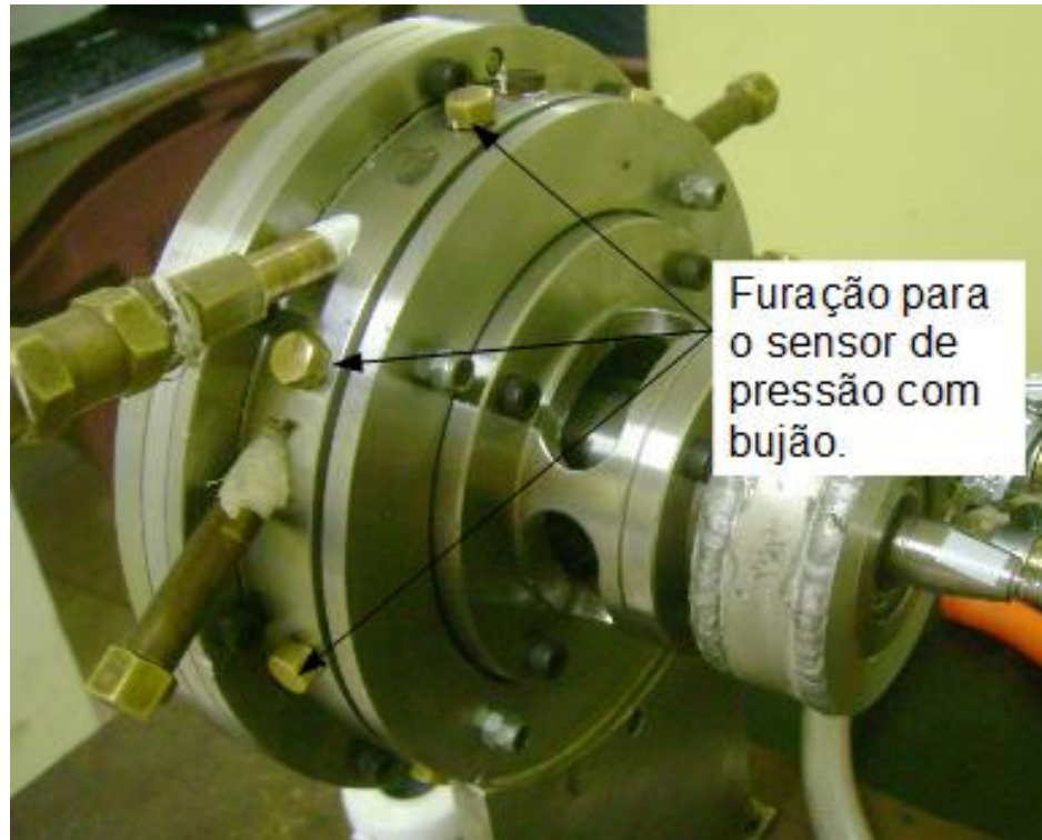
Figura 4.39 – Furação para montagem do sensor de pressão
