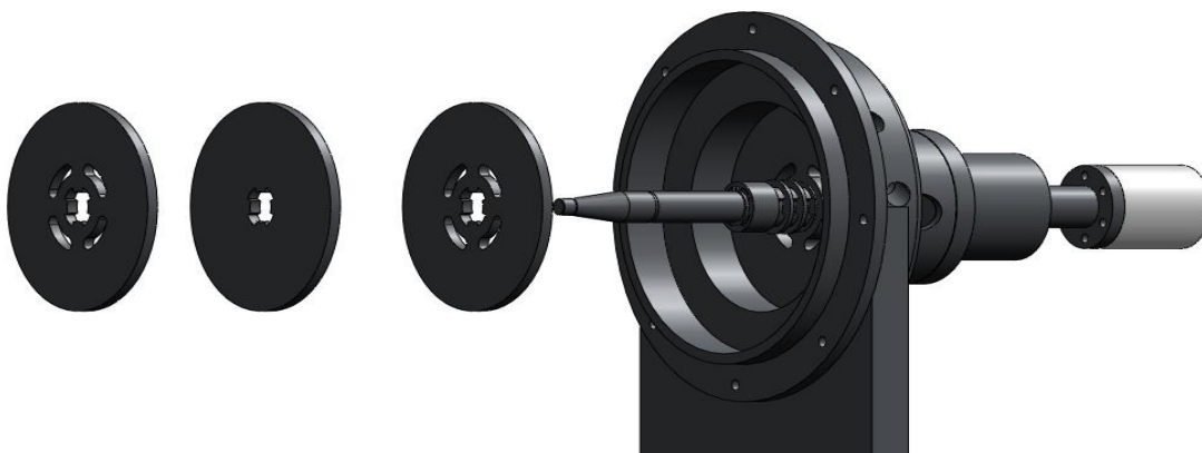
Figura 4.9 – Ordem de montagem dos discos para configuração de três discos
