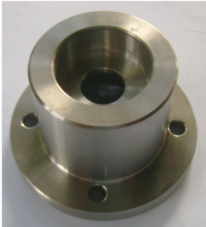
Figura 9.5 – Carcaça dos rolamentos.
