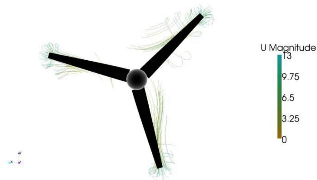
Figura 6.6 – Ganho de momento angular do fluido ao passar pelo rotor.
