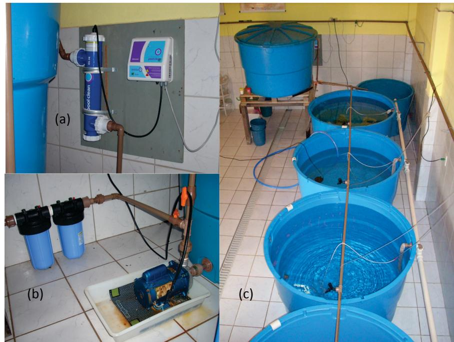
Figura 24 - Sistema de recirculação fechado utilizado na larvicultura do *L. synagris*, mostrando filtro UV (a), os filtros de cartucho (b) e os tanques de larvicultura (c).
