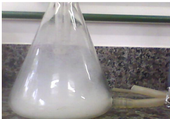
Figura 28 - Coletor de espuma com um volume de 2 L conectado ao gás efluente do fermentador. O reciclo celular foi designado para devolver uma parte do líquido da cultura de volta para o fermentador.
