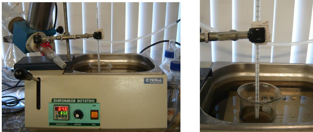
Figura 4 - Sistema utilizado para a realização do experimento para avaliação da capacidade calorífica dos encapsulantes.
