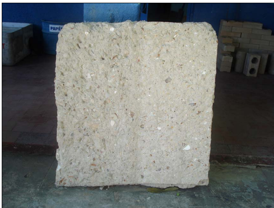
Figura 6A- Placa de concreto feita com RCD e utilizada na construção de paredes
