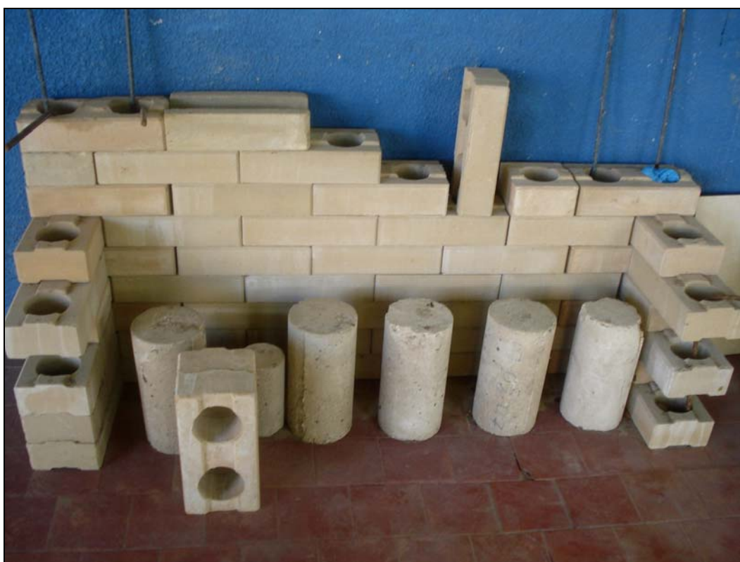
Figura 2A- Tijolos e blocos fabricados com RCD
