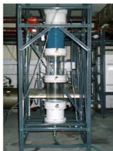
Figura 6 – Reator de fermentação anaeróbica UASB (reator de manta de lodo com fluxo ascendente).
