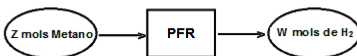
Figura 37 – Diagrama de blocos representando o balanço de número de mols da etapa de craqueamento termocatalítico (TCC).
