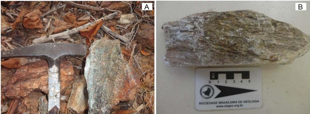
**Figura 4.8** – (A) Blocos de talco-clorita xistos associados a rochas talco-silicosas (NOEU-26); (B) Amostra de serpentina-talco xisto (NOEU-29A).
