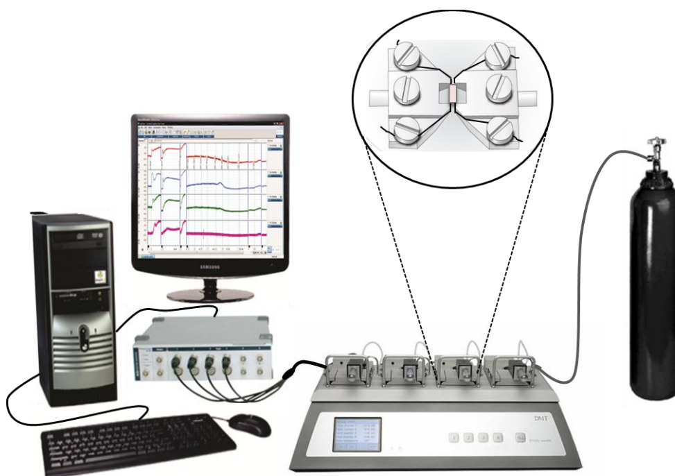
Figura 3 – Representação esquemática do sistema para vasos de resistência isolados (miógrafo) com preparação da artéria renal
