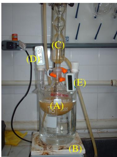
**Figura 3.4** - Aparato experimental: (A) balão de reação; (B) chapa aquecedora; (C) condensador de refluxo; (D) termômetro de controle da temperatura reacional; (E) termômetro de controle da temperatura da água.
