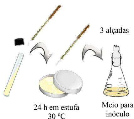
Figura 6 – Esquema ilustrativo do processo de propagação do inóculo
