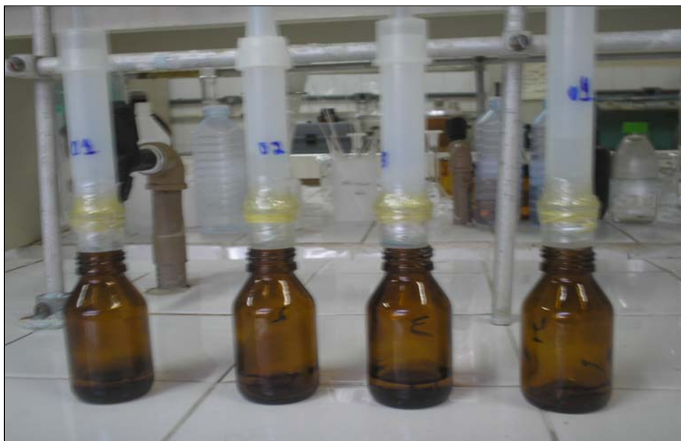
Figura 24: Sistema de cartuchos com os filmes e membranas de quitosana para adsorção dos íons metálicos Cu (II) e Pb (II).
