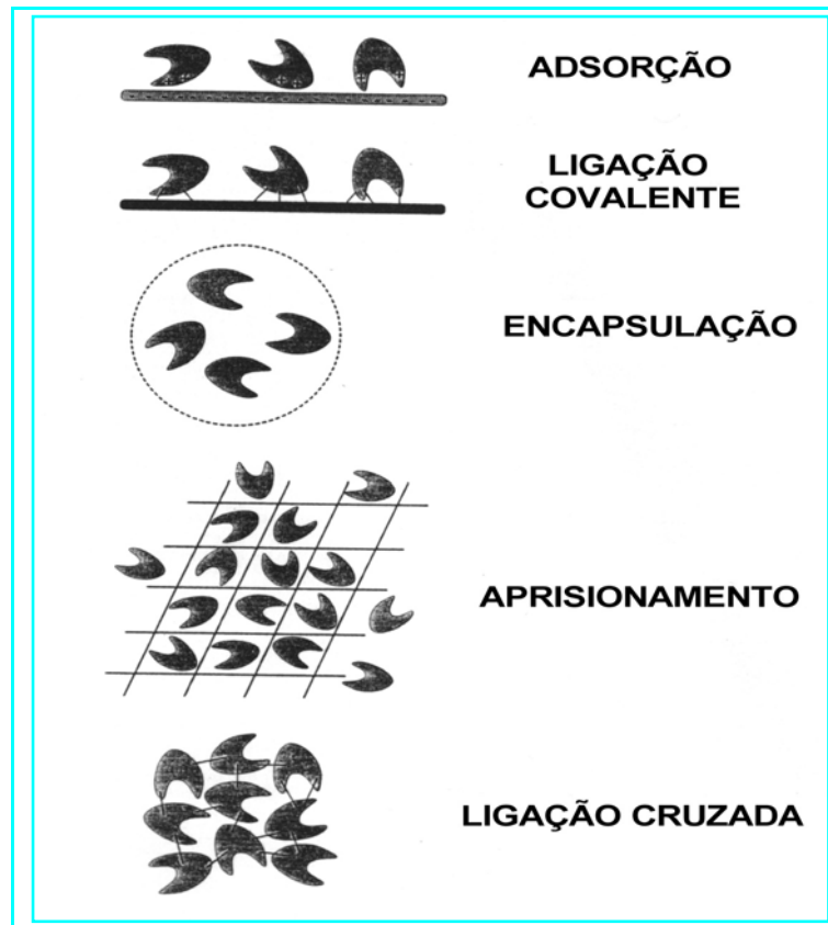
Figura 1: Principais métodos de imobilização. Adaptado de BICKERSTAFF, 1997.
