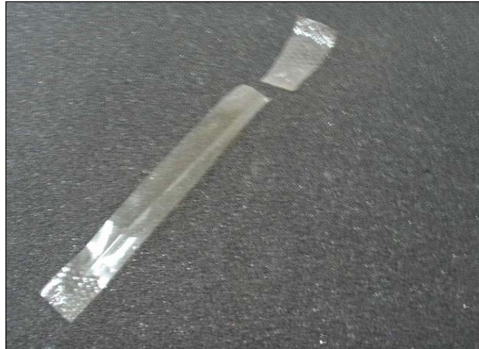
Figura 23: Aspecto do rompimento da membrana de quitosana com S. saprophyticus imobilizada.
