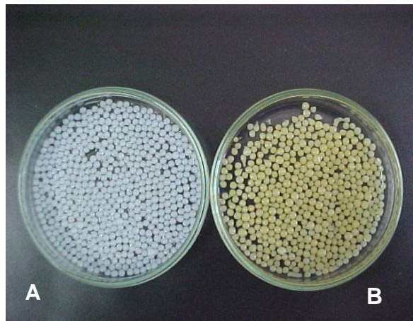
Figura 14: Esferas de quitosana (A) e esferas de quitosana contendo células da bactéria Staphylococcus saprophyticus PFA001 immobilizadas na proporção 1:1 (m:m) quitosana: biomassa (B).
