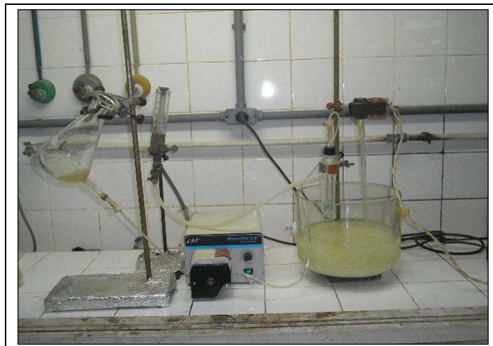
Figura 7: Sistema de produção de esferas de quitosana.
