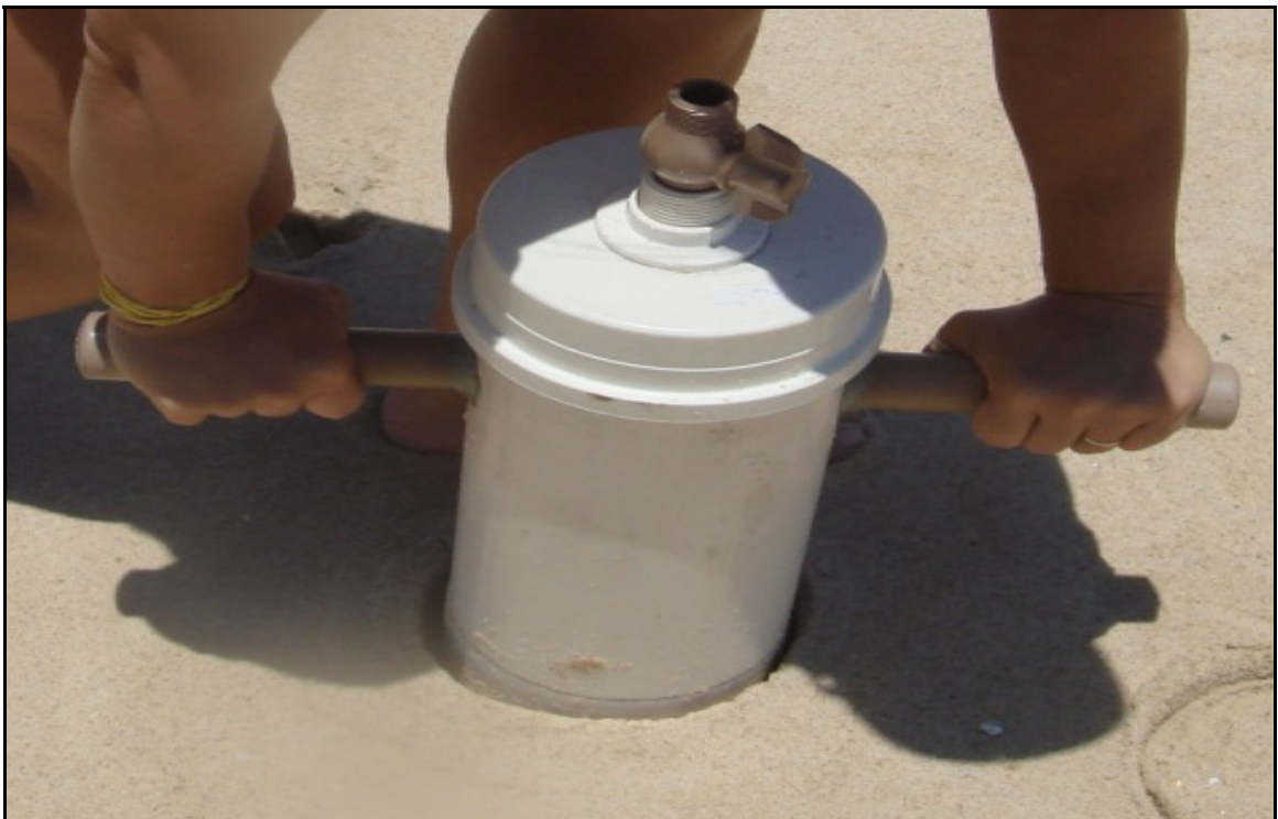
Figura 11 – Equipamento ( core ) utilizado para amostragem da macrofauna bentônica de substrato inconsolidado.
