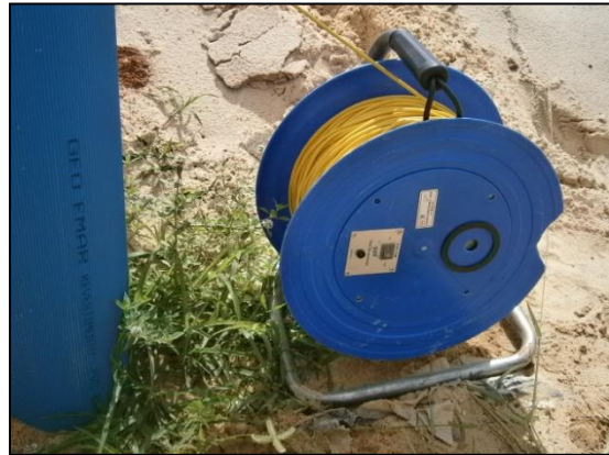
Foto 02 - Medidor eletro-sonoro de nível estático Jaciri com capacidade para 100 metros
