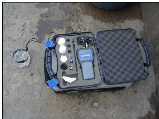
Foto 04 - pHmetro modelo MA 522/P Marconi
