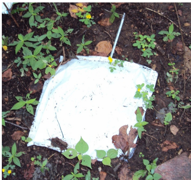
Figura 5- Detalhe da mensuração da temperatura sob uma sacola em contato direto com o solo.
