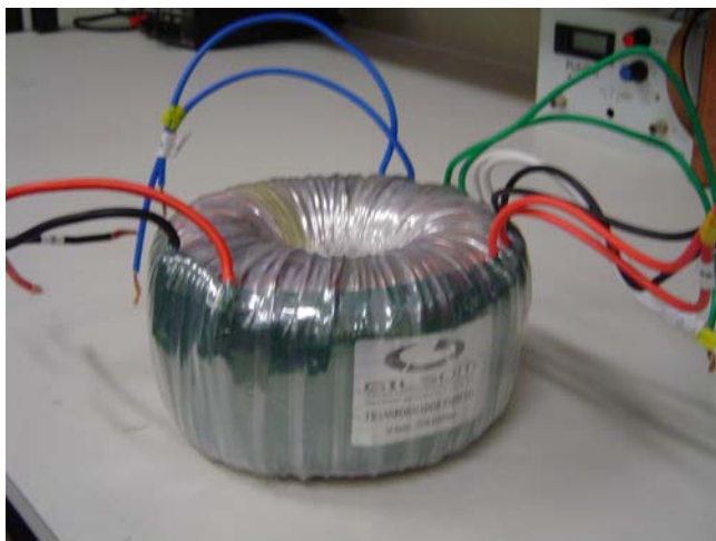
Figura 4.28: Transformador toroidal implementado para uma frequência de 300Hz.
