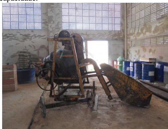
Figura 9- Betoneira auto-carregável com 600L de capacidade.
