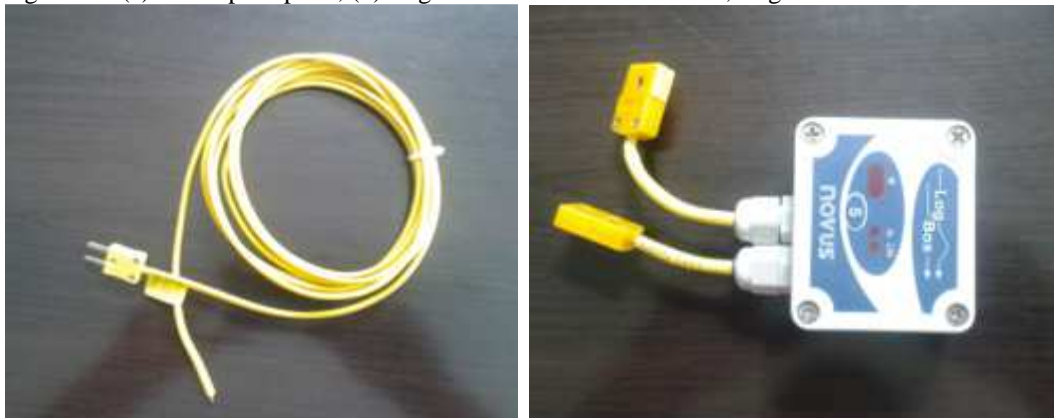
Figura 12- (a) Termopar tipo K; (b) Registrador eletrônico de sinais, LogBox-AA.
