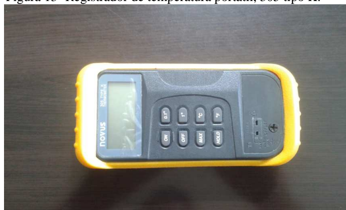
Figura 13- Registrador de temperatura portátil, 305 tipo K.
