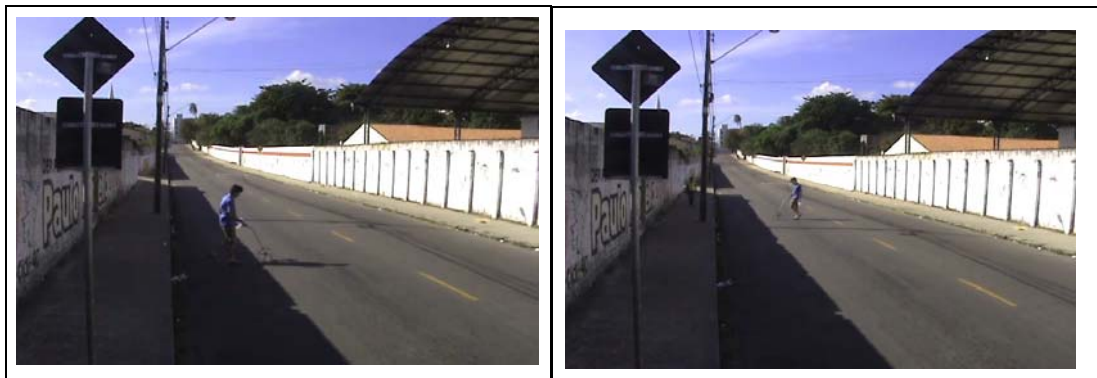
Figura 3.2: Exemplo de trecho com a utilização do método de filmagem para obtenção da velocidade veicular
