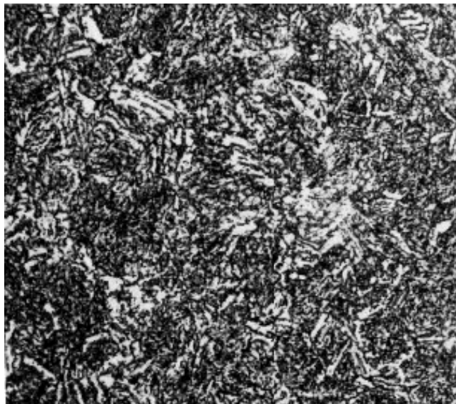
Figura 3 – Aço 4140 temperado em óleo e revenido a 621 °C por duas horas.
