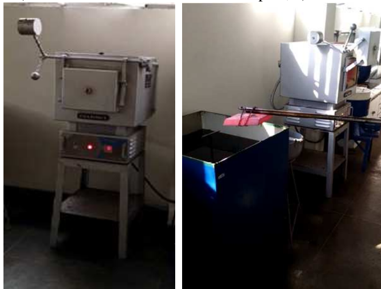
Figura 33 – a) Forno BRASIMET utilizado na têmpera; b) Resfriamento em óleo.
