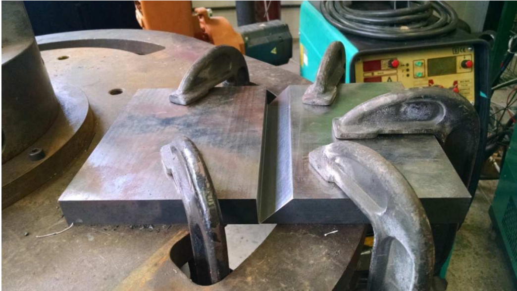
Figura 36 – Sistema de fixação na soldagem de juntas.
