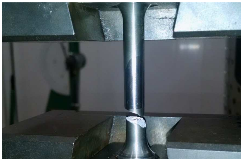
Figura 79 – Corpo de prova de tração da junta MBT.
