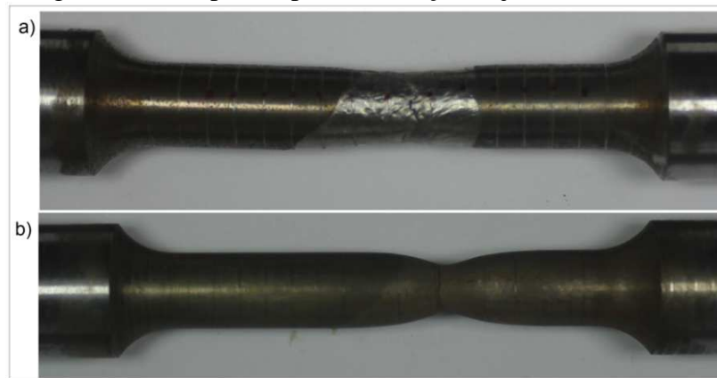
Figura 80 – Corpos de prova de tração a) junta A308 e b) BL.
