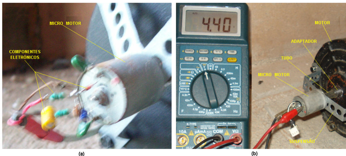
Figura 3.29 Em (a) micro-motor, e componentes eletrônicos em (b) componentes do acoplamento
