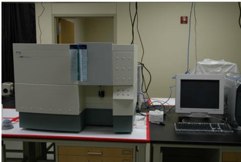
FIGURA 18: Equipamento de citometria de fluxo (BD® - Becton Dickinson FACSCalibur™) (ARQUIVO PRÓPRIO).
