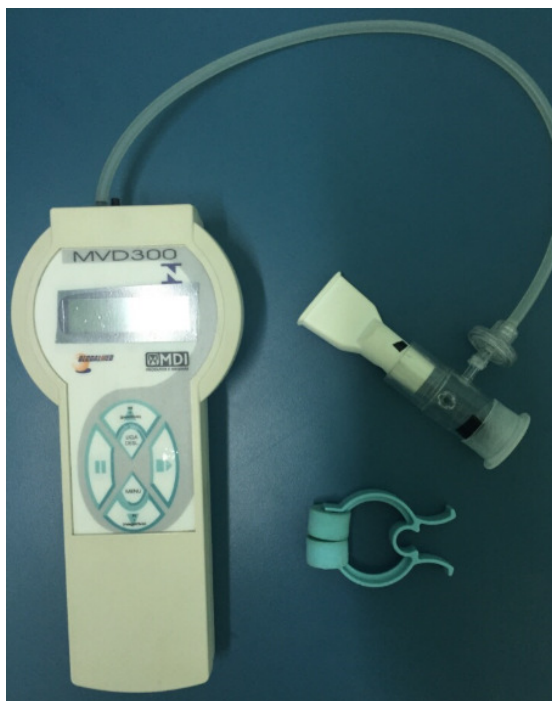
Figura 2 - Circuito do Manovacuômetro digital MVD 300 da Globalmed®, para mensurações da Pressão Inspiratória máxima e Pressão Expiratória máxima.
