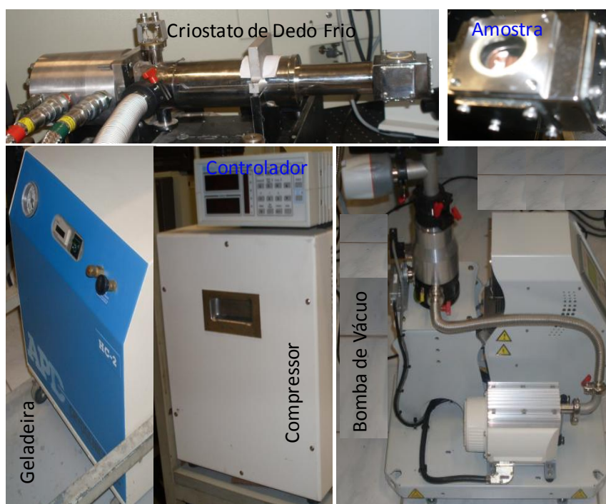
Figura 22. Equipamentos do sistema de resfriamento. [10]
