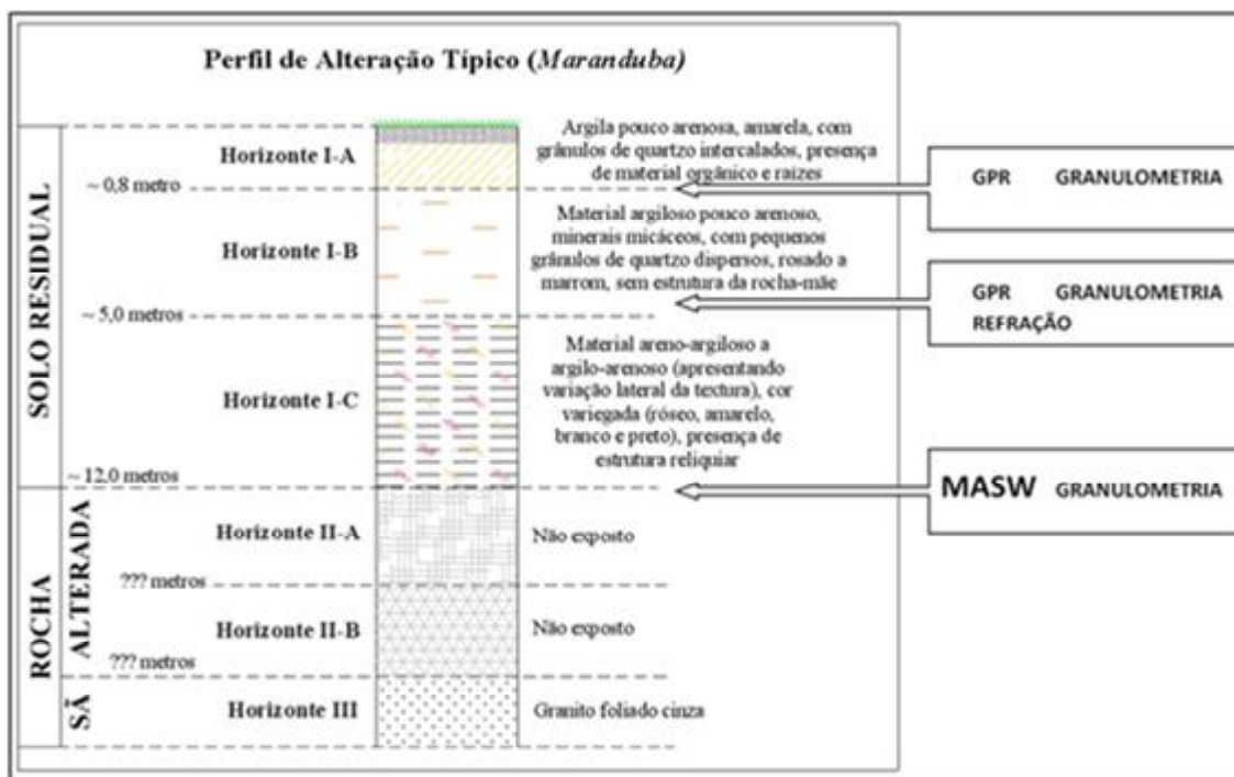
Fig. 12 - Perfil de alteração típico do local dos ensaios com a identificação das interfaces de cada método usado. (modificado do relatório parcial do Projeto FAPESP nº 03/07182-5).
