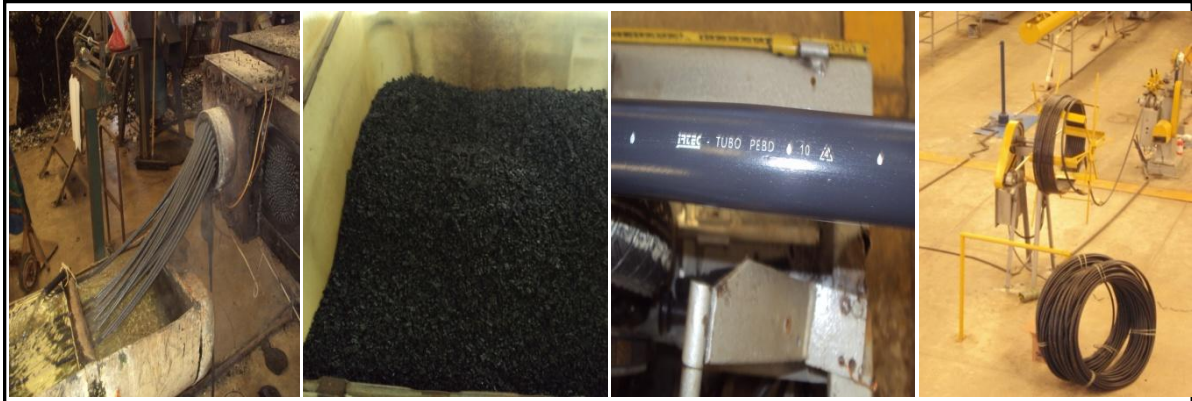
Figura 23 – Processo de extrusão dos grãos de plásticos recicláveis e dos tubos flexíveis da empresa IRTEC. Fonte: elaborado pela autora.
