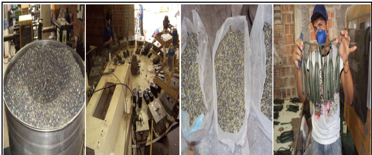
Figura 24 – Produção dos grãos de plásticos recicláveis para a transformação de solados e cabrestos. Fonte: Elaborado pela autora
