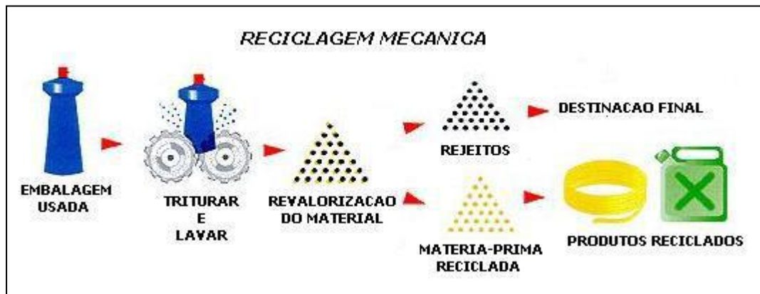
Figura 2 – Processo da reciclagem de resíduos plásticos pelo método mecânico. Fonte: http://www.plastivida.org.br/reciclando/mecan.htm
