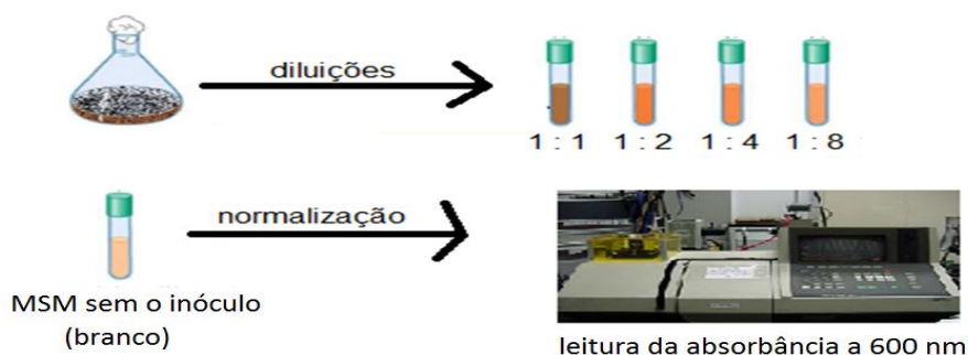
Figura 7- Metodologia empregada na etapa de construção da curva de calibração para contagem do inóculo por densidade óptica
