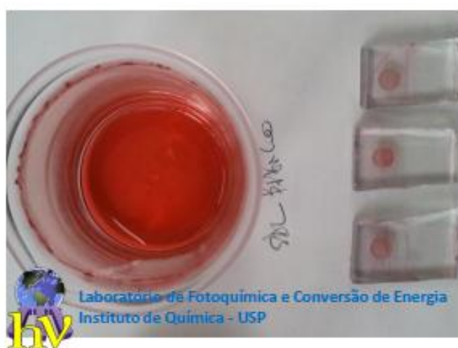
Figura 26. Solução metanólica de [\text{Ru}(\text{dcbpy})(\text{bpy})(\text{bqdi})] a 1,5 \times 10^{-3} \text{ mol L}^{-1} e células solares sensibilizadas utilizando-se este complexo.
