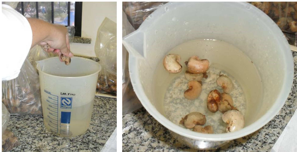
Figura 5 - Teste de densidade realizado no Laboratório de Fitopatologia da Embrapa Agroindústria Tropical (Fortaleza, 2013)
