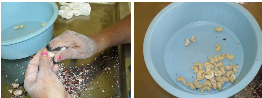
Figura 15 - Processo de despeliculagem realizado na Fábrica de beneficiamento de castanhas da Embrapa Agroindústria Tropical (Pacajus, 2013)
