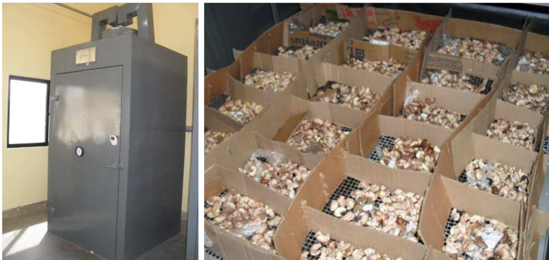
Figura 14 - Processo de estufagem realizado na Fábrica de beneficiamento de castanhas da Embrapa Agroindústria Tropical (Pacajus, 2013)
