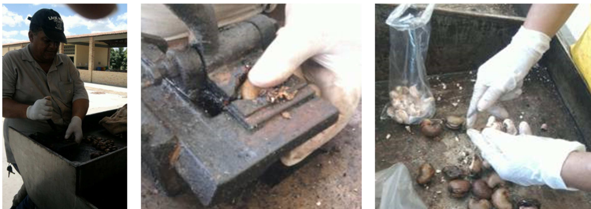
Figura 12 - Processo de decorticação realizado na Fábrica de beneficiamento de castanhas da Embrapa Agroindústria Tropical (Pacajus, 2013)
