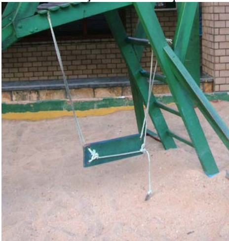
Foto 10 – Balanço com a corda quebrada
