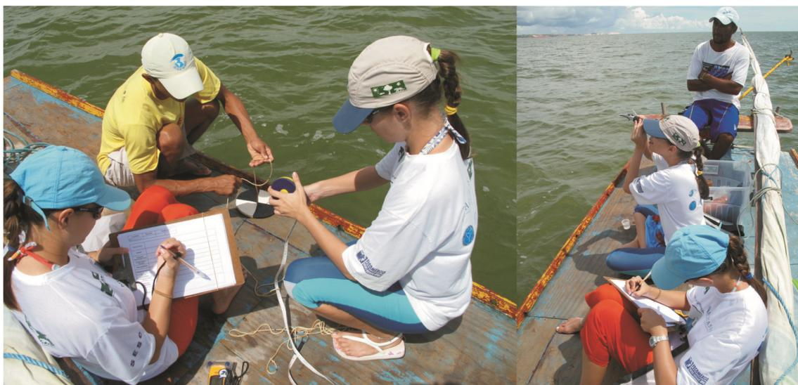
**Figura 26** – Equipe medindo a profundidade da barra do rio (a esquerda) e a salinidade (a direita).
