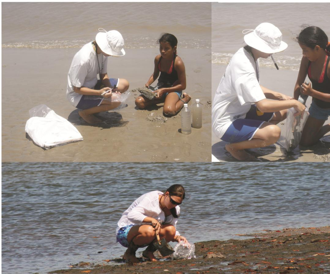
**Figura 29** – Amostras de sedimento sendo coletadas.
