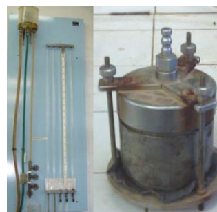
(b) Permeâmetro fechado junto ao sistema de entrada de água (cilindros graduados)
