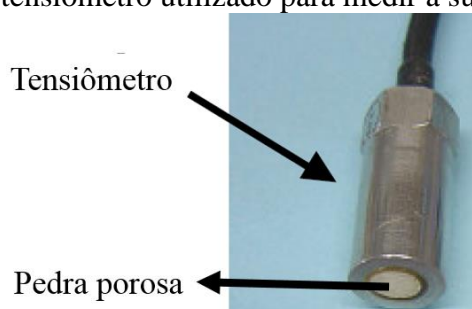
Figura 29 - Exemplo de um tensiômetro utilizado para medir a sucção
