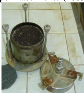
(a) Vista do permeâmetro aberto com o CP posicionado internamente
