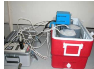
(d) Psicômetros conectados ao sistema que registra os dados
