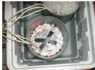
(c) Amostra dentro de um sistema com controle de temperatura
