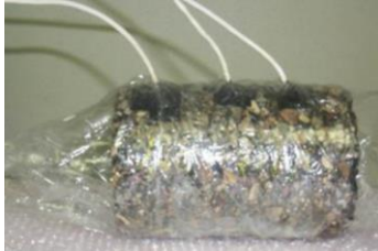
(a) Três psicômetros inseridos na amostra
