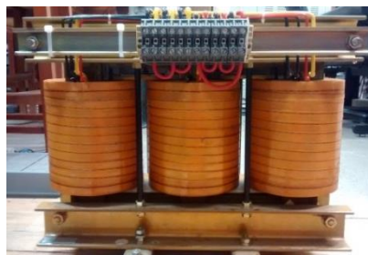
Figura 4.1: Transformador a seco trifásico utilizado no estudo.
