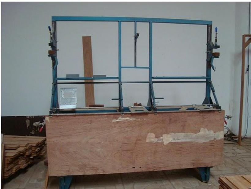
**Figura 5.10** – Máquina centro de montagem de porta pronta
