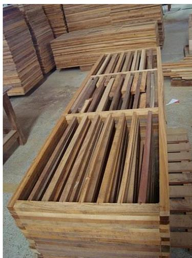
**Figura 5.7** – Núcleo das portas prontas de madeira
