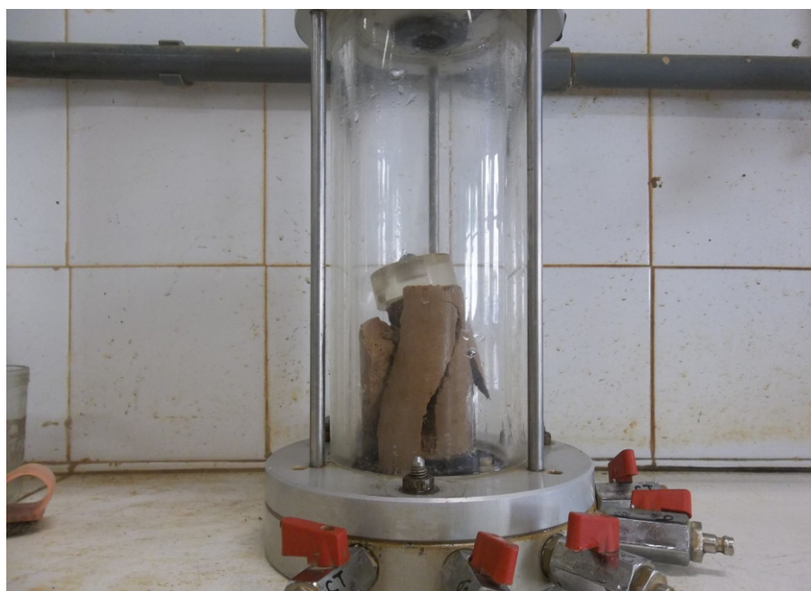
Figura 4.9 – Aspecto geral dos corpos-de-prova após a ruptura.
