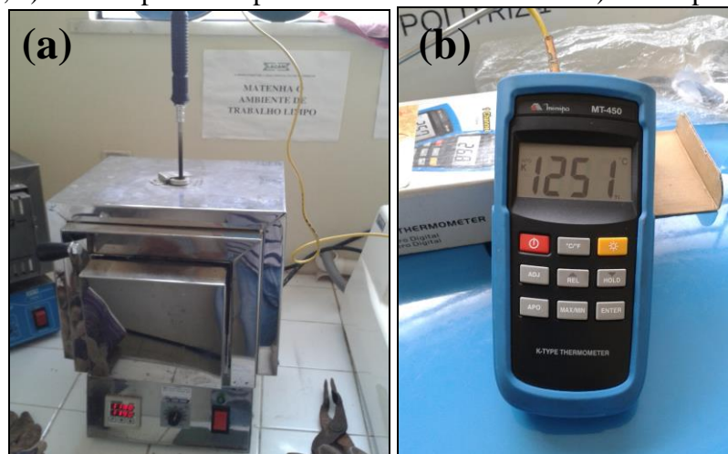
Figura 19 - Foto do; a) Forno tipo mufla para tratamentos térmicos e b) Termopar MT-450
