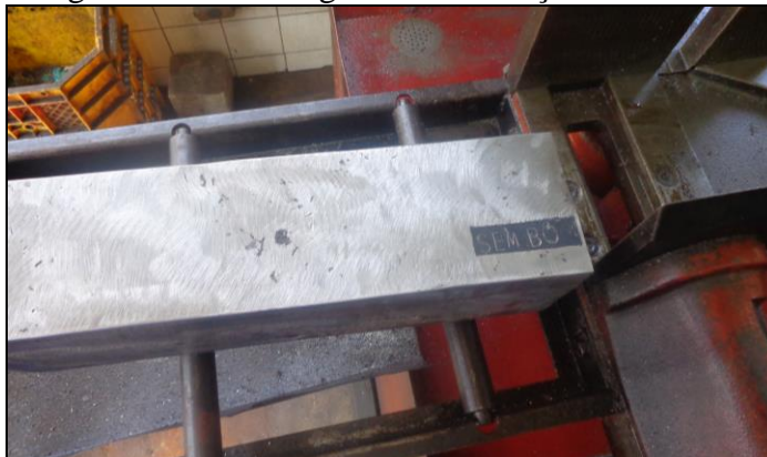
Figura 15 - Lingote fundido da liga modelo de aço inoxidável superferrítico sem boro (LSB)
