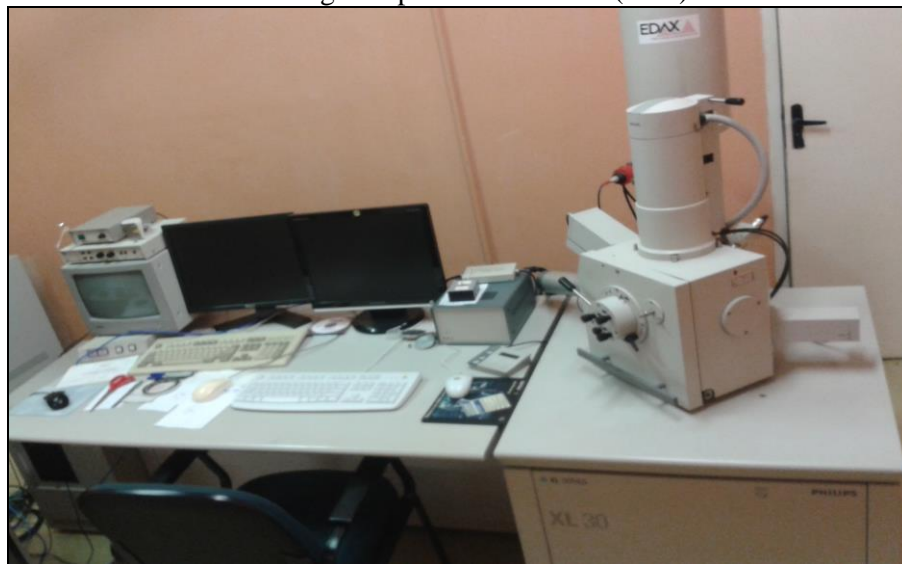
Figura 22 - Microscópio Eletrônico de Varredura de marca Philips modelo XL 30 acoplado com um detector de energia dispersiva de raios-x (EDS) de marca EDAX
